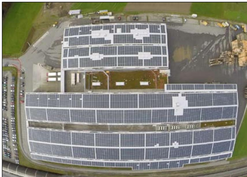
**Knapp 5800 Photovoltaik-Module wurden auf einer Fläche von 9360 m<sup>2</sup> installiert. Eine Jahresleistung von 1,42 Gigawatt, was dem Strombedarf von 280 Einfamilienhäusern oder zwei Drittel des Eigenbedarfs der Terralog ag entspricht.** Bild: zvg
